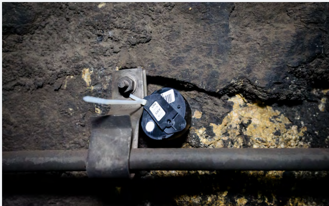
Détecteur DSTN pour la mesure intégrée de l'activité volumique en radon Photo © Arnaud Bouissou / Terra
