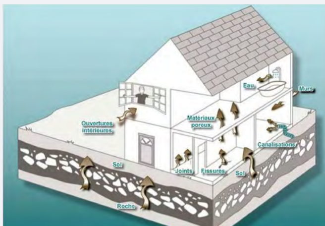
Voies de pénétration du radon dans une maison Source : Agence de Sécurité Nucléaire (ASN)
