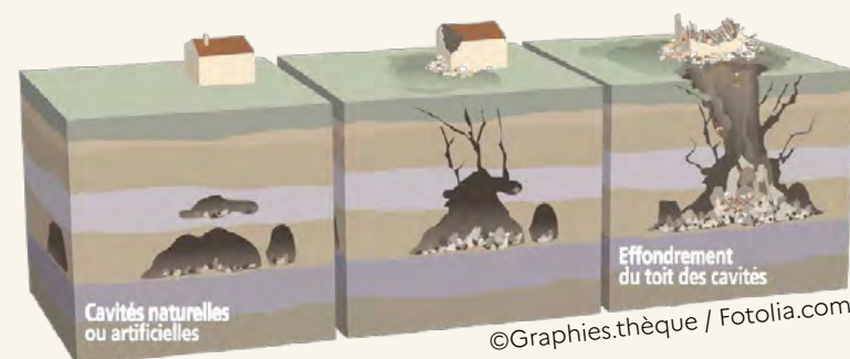
Effondrement du toit d'une cavité souterraine
