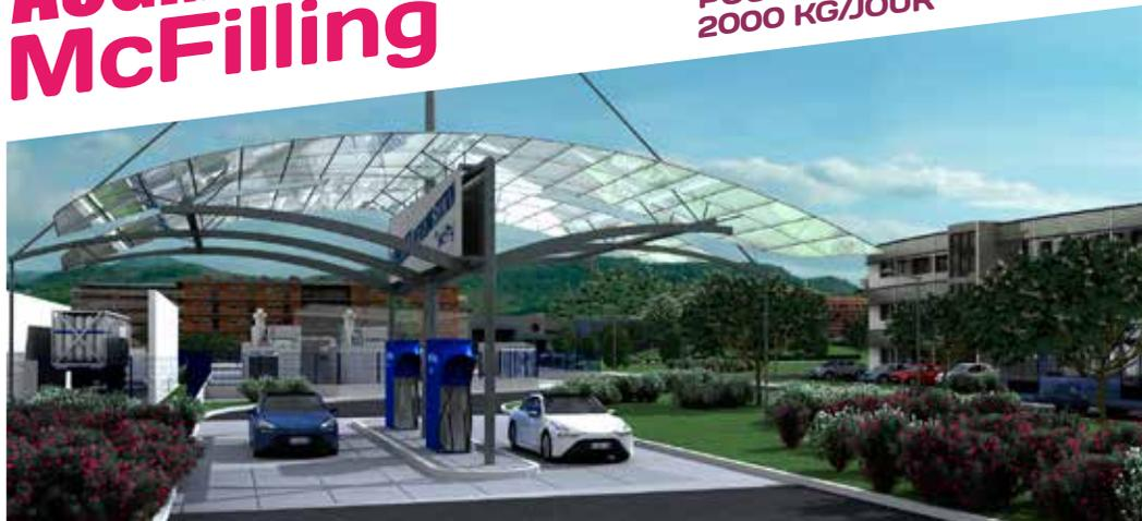
Infrastructure de recharge hydrogène ("HRI") | Configuration 1600 kg / jour, incluant un McLyzer 800-30 pour la production sur site de l'équivalent de 4 MW d'hydrogène. Scénarios de ravitaillement possibles : 320 véhicules légers, 40 camions, 80 bus. Possibilité d'exporter de l'hydrogène par remorques "tube trailers" jusqu'à 500 bar, pour des utilisations distantes du point de production.
