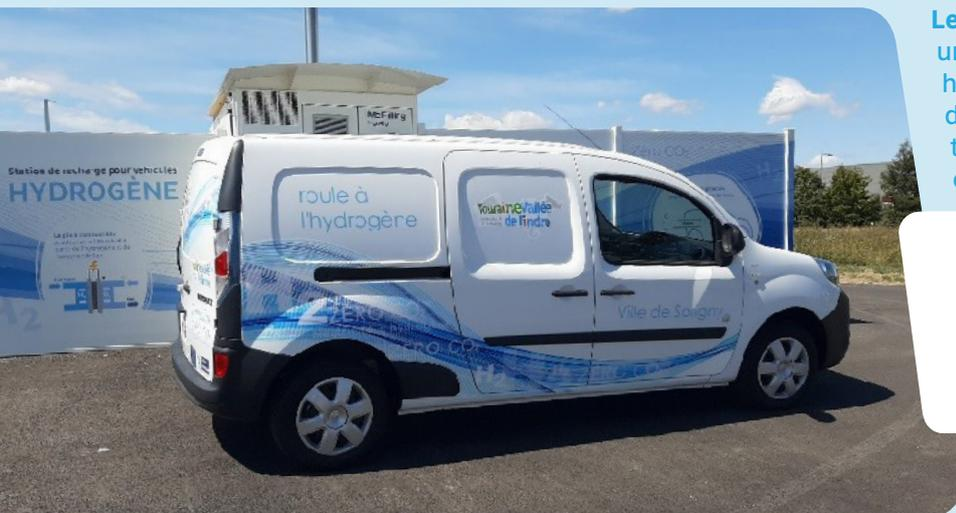
Le Kangoo ZE H2 est issu de l'installation dans un Kangoo ZE électrique basique d'un réservoir hydrogène d'une capacité de 1,8 kg à 350 bars, et d'une pile à combustible. Le rôle de la pile est de transformer l'hydrogène gazeux en électricité, ce qui rejette de l'eau :
